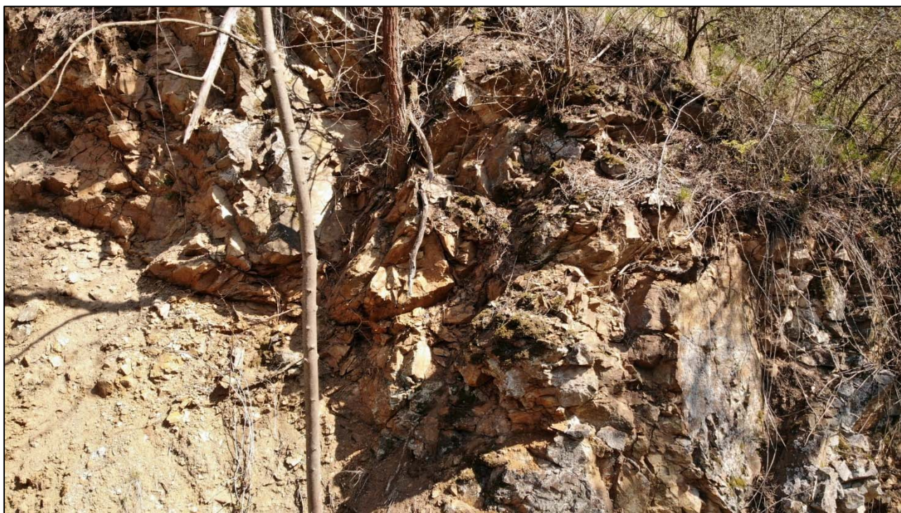
Obr. 78: stav extrémního zvětrání horních částí masívu včetně vlivu kořenového systému stromů
