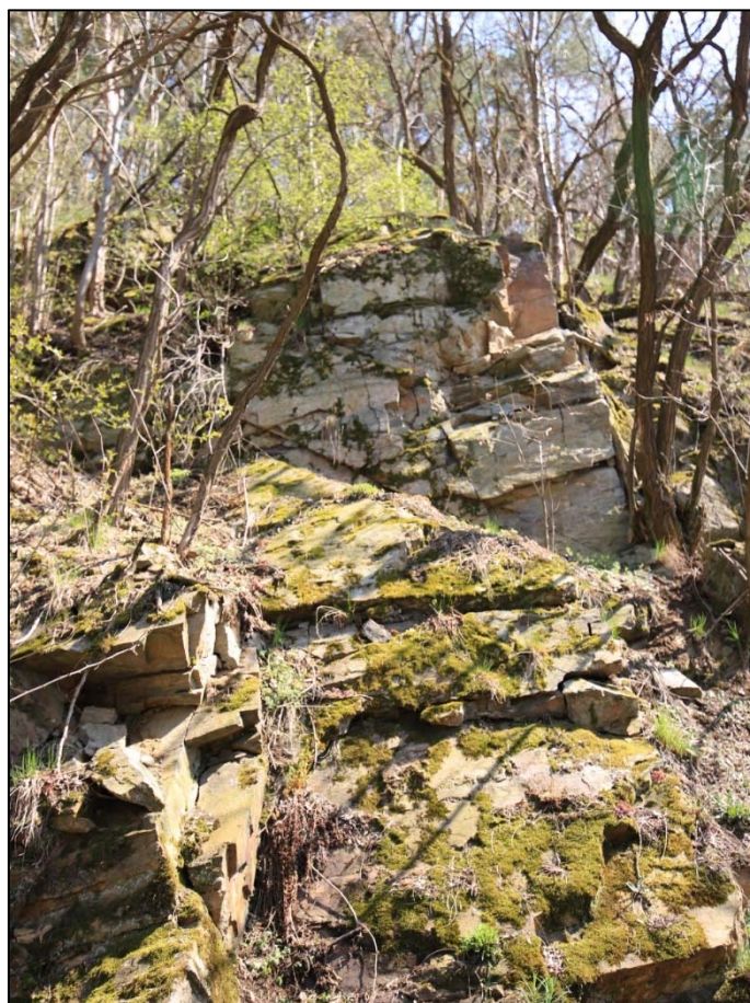
Obr. 105: Příklad blokového rozpadu masívu podél predisponovaných ploch foliace a tektonických poruch, nepříznivý úklon ploch odlučnosti cca 45° ze svahu, km 19,180
