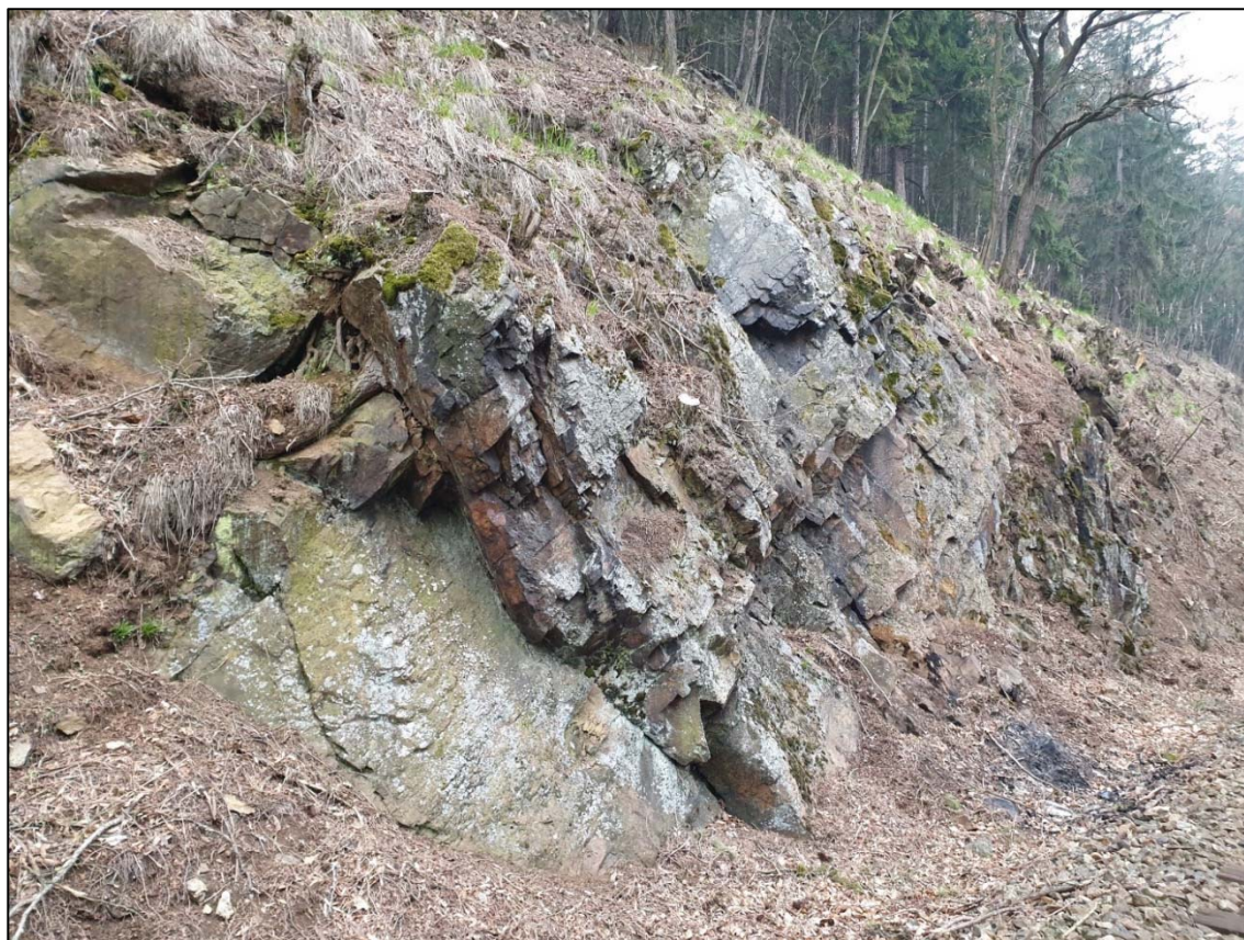
Obr. 235: morfologická stavba a stav zvětrání skalního masívu v km 31,876, rozevření puklin 10 – 50 mm, výrazný systém ploch odlučnosti
