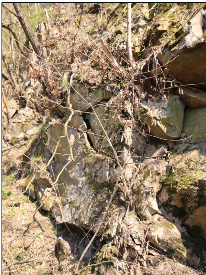
Obr. 108: detail narušení masívu, otevření puklin 15 – 65 mm s uplatněním klínového a pákového efektu od vegetace
