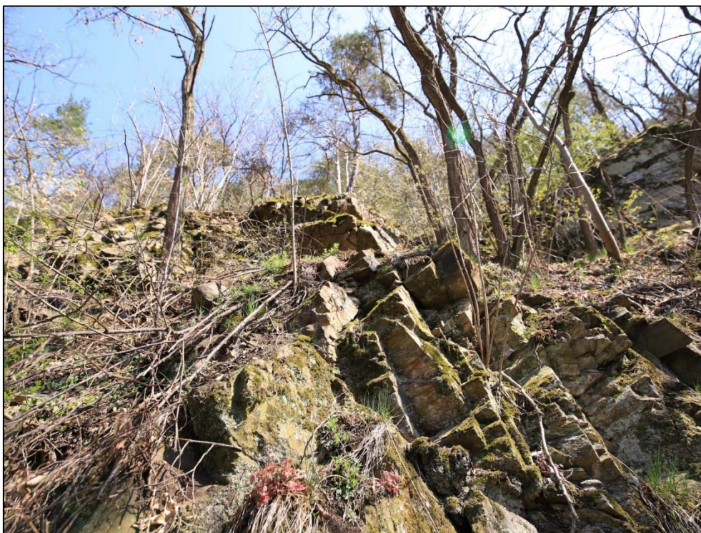
Obr. 104: detail četnosti a charakteru ploch odlučnosti skalního výchozu v km 19,175
